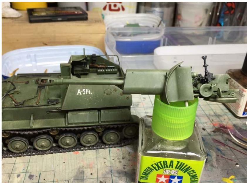
主砲はポリキャップで車体と接合するようになっていいますので、車体と別々に製作することができ、製作中の破損などのトラブルを避けられます。主砲の組立ても組立て説明図どおり進めます。もちろん何の問題ありません。組み上がれば、オキサイトレッドサーフェーサー→オリブグリーンで塗装。組立て説明図の指示に従い細かい部分を塗り分けます。
